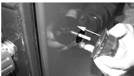
Abbildung 3: Montage des Leistungsreglerknopf
